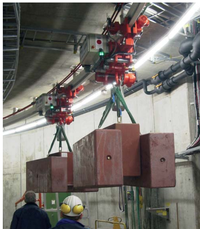
Kurvenfahrt curved beam fer courbe
