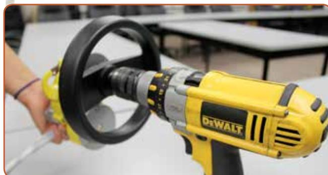
Die hervorstehende Welle mit 10 mm Durchmesser auf der Kurbel wird als Bohradapter verwendet. Schließen Sie die Bohrmaschine an, um die Geschwindigkeit zu kontrollieren und/oder den verunglückten hochzuziehen. Empfohlenes Mindest-Drehmoment: 45 nm. Mindest-Drehgeschwindigkeit: 0-300 Drehungen/min.
