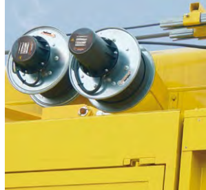
Federleitungstrommeln Stock&Go auf einem schienengebundenen Mobilkran
