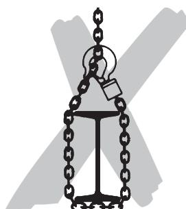
Łańcucha nośnego nie zwężać i nie skracić przy użyciu sworzni, śrub, wkrętaków i tym podobnych. łańcuchy ładunkowe zamontowane na stałe w dźwignicach nie mogą być naprawiane.
