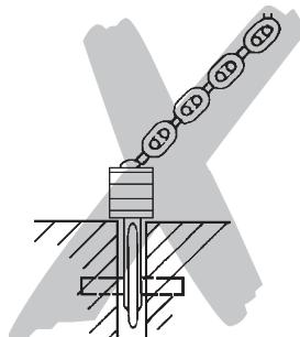
De lastketting mag niet worden gebruikt als aanslagketting (stropketting).
