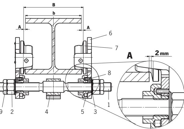
**Монтаж ручной цепи (только тележки с лебёдочным приводом)**
