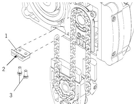
Successivamente l'ancoraggio della catena viene nuovamente avvitato all'alloggiamento. Vengono quindi impiegate viti di sicurezza nuove, prerivestite e monouso.
