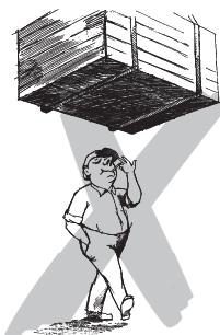
Les charges ne doivent pas être suspendues, accrochées ou laissées sans surveillance trop longtemps.
