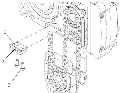
Végül ismét csavarozzák be a lánchorgonyt a burkolathoz. Használjon új rétegzett, egyszer használatos biztonsági csavarokat.
