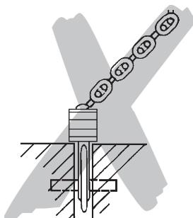
Грузовую цепь нельзя применять в качестве цепного стропа (путевой цепи).
