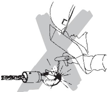
Schrägzug, d.h. seitliche Belastungen des Traghakens (bzw. des Fahrwerks bei entsprechend ausgestatteten Modellen), des Gehäuses oder der Unterflasche ist verboten. Das optionale Fahrwerk muss sich zu jedem Zeitpunkt lotrecht über der Last befinden.
