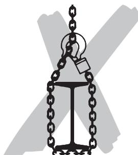
Ne pas faire de nœuds dans la chaîne de charge ou la raccourcir à l'aide de chevilles, boulons, tournevis ou autre. Ne pas réparer les chaînes de charge installées dans le treuil.
