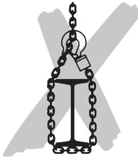
No atar la cadena de carga ni acortar con tuercas, tornillos, destornilladores o similares. Las cadenas de carga montadas firmemente en el elevador no deben ser reparadas.
