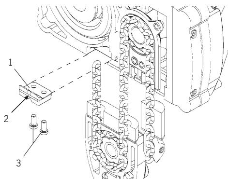
Revisser l'ancrage de chaîne sur le carter. Pour ce faire, n'utiliser que des vis de sécurité pré-enduites à usage unique.
