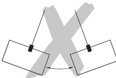
Éviter tout fonctionnement excessif par à-coups (actionnements brefs et répétés du commutateur de commande).
