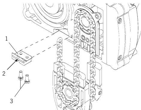
Daarna wordt het kettingeindstuk weer op de behuizing geschroefd. Daarbij worden nieuwe, gecoate veiligheidsschroeven gebruikt, die slechts eenmaal mogen worden gebruikt.
