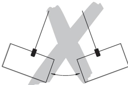
Evitare l'eccessivo funzionamento a impulsi azionando brevemente e ripetutamente l'interruttore di controllo.
