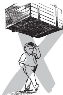
A felemelt vagy befogott terhet nem szabad hosszú ideig felügyelet nélkül vagy felemelt/befogott állapotban hagyni. A kezelő csak azután kezdheti el a teher mozgatását, ha meggyőződött róla, hogy a terhet megfelelően rögzítették és a veszélyzónát minden személy elhagyta.
