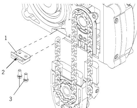
În final, ancora de lanț va fi din nou însurubată cu carcasa. Pentru aceasta trebuie să fie folosite șuruburi de securitate preacoperite, care nu se pot folosi decât o singură dată.
