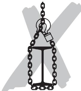
Lanțul de sarcină nu se va înnoda sau nu se va scurta cu bolturi, șuruburi, șurubelnițe sau altele similare. Lanțurile de sarcină încorporate prin incastrare în mașina de ridicat nu trebuie să fie supuse reparației.
