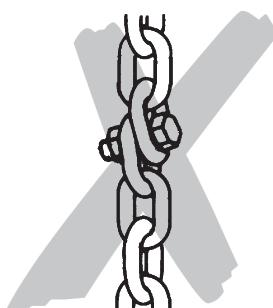
Удаление предохранительной скобы несущего или грузового крюка недопустимо.
