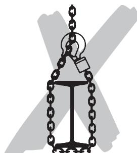
Yük zinciri civata, vida, tornavida vb. ile kısaltılamaz. Kaldırma ekipmanlarına sabit monte edilmiş olan yük zincirleri onarılamaz.
