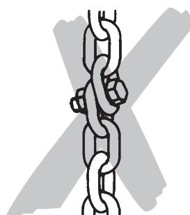
Het verwijderen van de veiligheidsbeugel van draag- of lasthaken is niet toegestaan.
