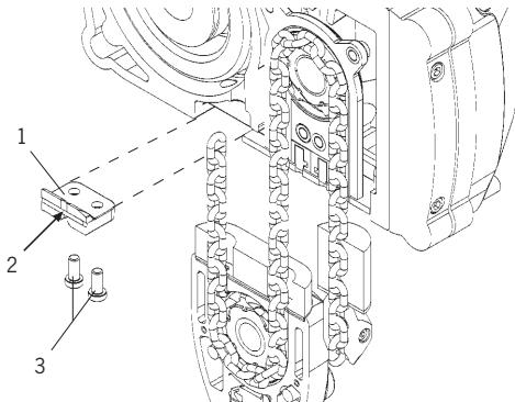
Anschließend wird der Kettenanker wieder mit dem Gehäuse verschraubt. Dabei kommen neue, vorbeschichtete Sicherheitsschrauben zum Einsatz, die nur einmal benutzt werden dürfen.
