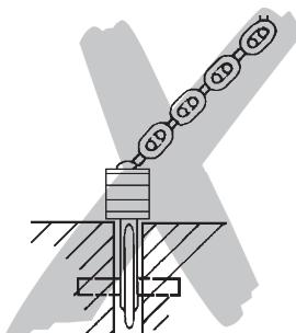
La chaîne de charge ne doit pas être utilisée comme élingue.
