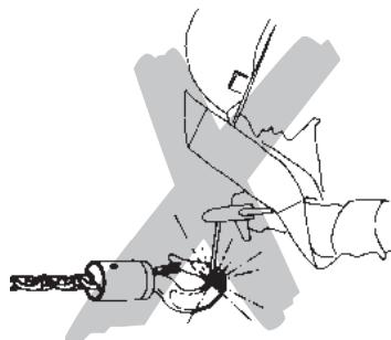
Tilos a függesztő horog (haladóművel felszerelt modelleknel a haladómű), a burkolat vagy az alsó blokk oldalirányú húzása, azaz oldalirányú terhelése (3. ábra). Amennyiben van haladómű, annak minden függőlegesen a teher fölött kell elhelyezkednie.
