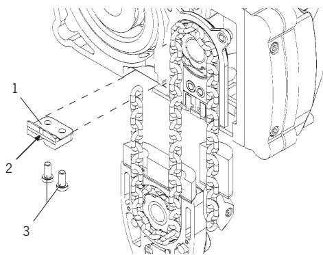
Вслед за этим цепной якорь снова свинчивается с корпусом. При этом можно использовать только новые стопорные винты с предварительным покрытием, которые ещё ни разу не применялись.
