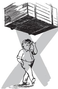
Lasten niet langere tijd of zonder toezicht in opgehesen of gespannen toestand laten.
