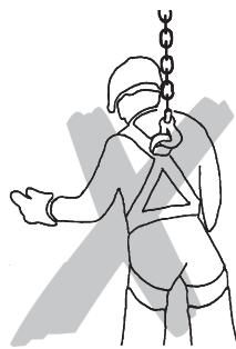
Se prohíben los trabajos de soldadura en el mecanismo de transporte, el/los gancho/s y la cadena de carga opcionales. No utilice la cadena de carga como toma a tierra en trabajos de soldadura.
