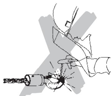
Se interzice tractarea oblică adică solicitările laterale ale cârligului de sarcină (respectiv ale mecanismului de deplasare la modelele corespunzătoare echipate), ale carcaselor sau ale palanului de scripeți inferior. Mecanismul de deplasare optional trebuie ca în orice moment să se situeze vertical deasupra sarcinii.
