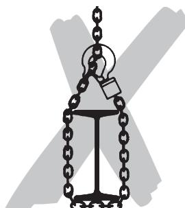
Ne csomózzák össze a teherláncot. A teherláncot ne kapcsolják össze csapszegek, csavarok, csavarhúzók vagy hasonlók használatával (7. ábra). A teherláncokon ne hajtsanak végre javítást, amikor azok be vannak építve az emelőszerkezetbe.
