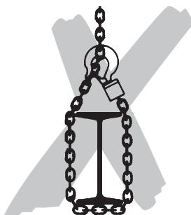
Грузовую цепь нельзя завязывать узлом или укорачивать с помощью болтов, винтов, отвёрток и т. п. Несъёмные грузовые цепи подъёмного механизма не ремонтировать.
