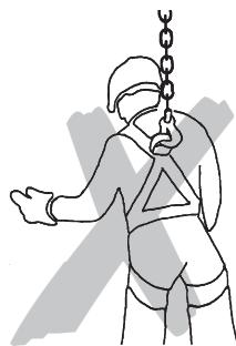
Сварочные работы на тележке (если есть) или на крюке и грузовой цепи запрещены. Нельзя использовать грузовую цепь в качестве заземления при сварочных работах.
