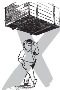
Lasten nicht über längere Zeit oder unbeaufsichtigt in angehobenem oder gespanntem Zustand belassen.
