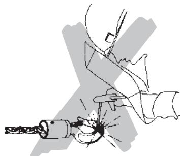
È vietata la trazione obliqua, ovvero i carichi laterali del gancio di sospensione (o del carrello nei modelli opportunamente equipaggiati), dell'alloggiamento o del bozzello con attacco inferiore. Il carrello opzionale deve trovarsi in qualsiasi momento perpendicolare al carico.
