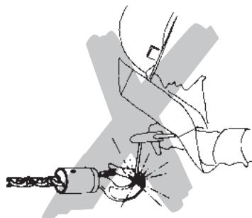
No se permite tiro lateral, es decir, cargas laterales del gancho de carga (o del mecanismo de transporte en los modelos correspondientes), de la carcasa o de la polea de gancho. El mecanismo opcional de transporte debe encontrarse vertical sobre la carga en todo momento.
