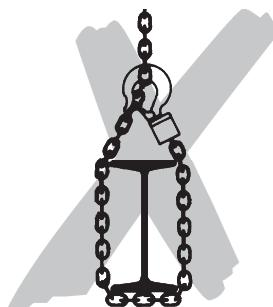
Lastkettingen niet knopen of met bouten, schroeven, schroevendraaier of dergelijke korter maken. Vast in hefwerktuigen ingebouwde lastkettingen mogen niet worden gerepareerd.
