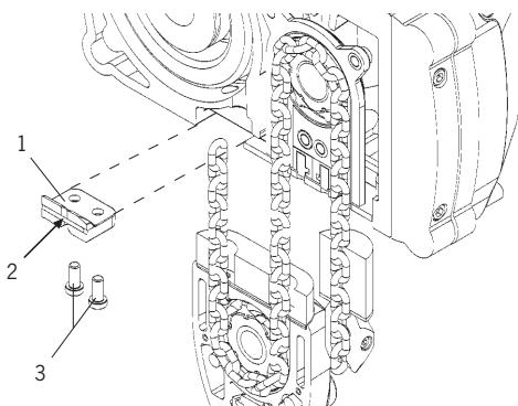
Después, se atornilla el anclaje de cadena nuevamente a la carcasa. Para ello, se utilizarán tornillos de seguridad nuevos y revestidos que solamente se podrán utilizar una vez. Par de apriete para los tornillos de sujeción:
