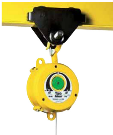
Öse für Sicherheitskette Nach DIN 15112 muss der Balancer mit einer zusätzlichen Sicherheitskette befestigt werden.
